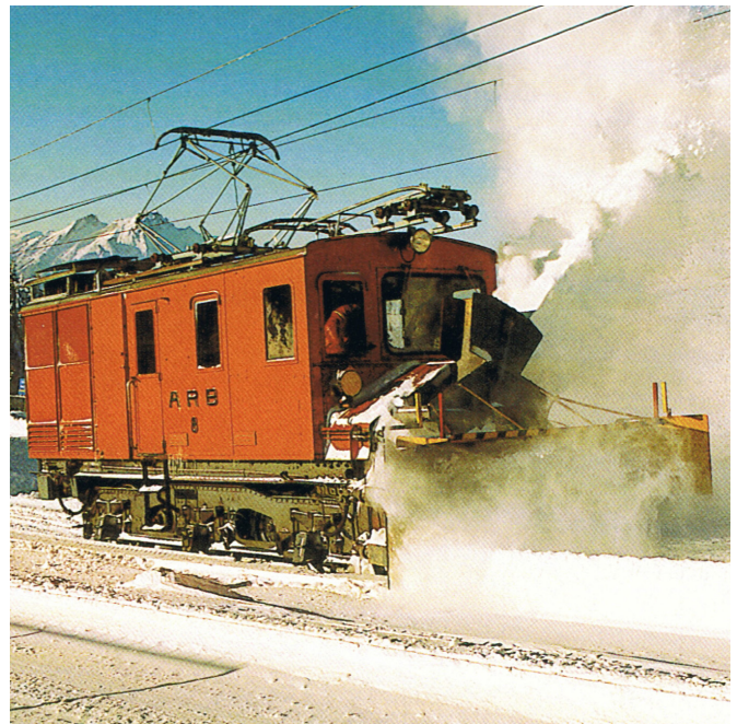
Die Schneeschleuder der Arth-Rigi-Bahn ARB, den heutigen Rigi Bahnen, kommt bei widrigsten Wetterverhältnissen zum Einsatz.
