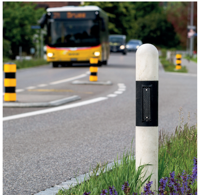
Il radar laterale Topo.slp installato nei paletti indicatori permette di effettuare le misurazioni in luoghi dove non è possibile montare altre apparecchiature.
