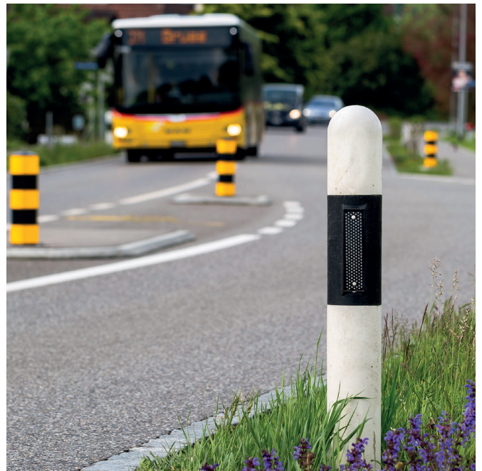
Der Seitenradar Topo.slp im Leitpfosten ermöglicht Messungen an Stellen, die keine Montagemöglichkeit für andere Geräte bieten.
