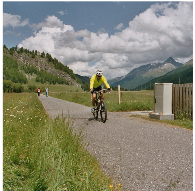
Les compteurs de vélos, montés dans d'élégants coffrets en plastique à proximité immédiate des itinéraires cyclotouristes, mesurent le trafic à l'abri des intempéries; photo prise à La Punt en Engadine.
