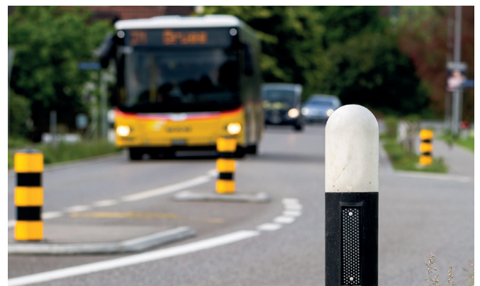
Der Seitenradar lässt sich unauffällig in Form eines Leitpfostens platzieren, so dass er das natürliche Verhalten der Verkehrsteilnehmer erfasst.
