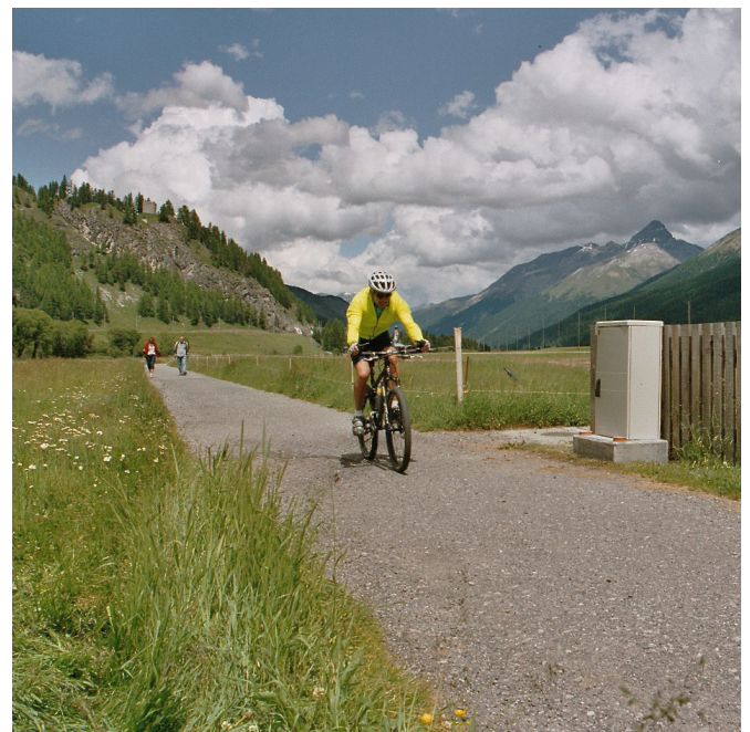
Die Velozähler wurden in Kunststoffschränken direkt an Velorouten montiert und erfassen so elegant und unabhängig von Witterungseinflüssen den Verkehr. Im Bild: Standort La Punt im Engadin.
